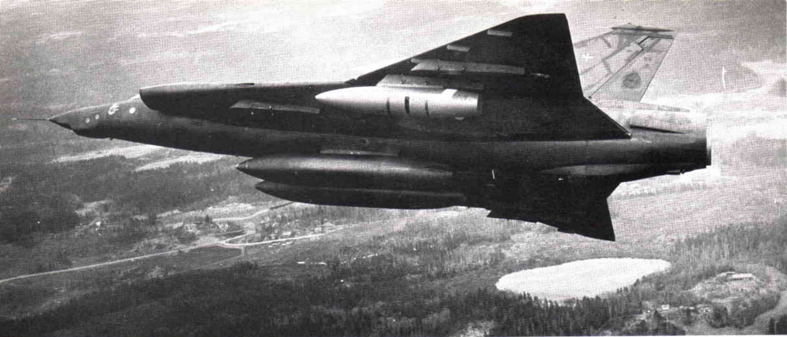
Danska flygvapnets Drakar får nu Red Baron, en ny dag- och nattspaningskapsel. Prototypen är målad i danska röd-vita färgerna, därav namnet.
